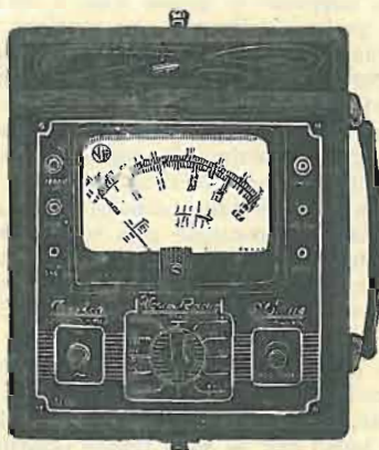
S. O. 114 TESTER 20.000 \Omega/V
